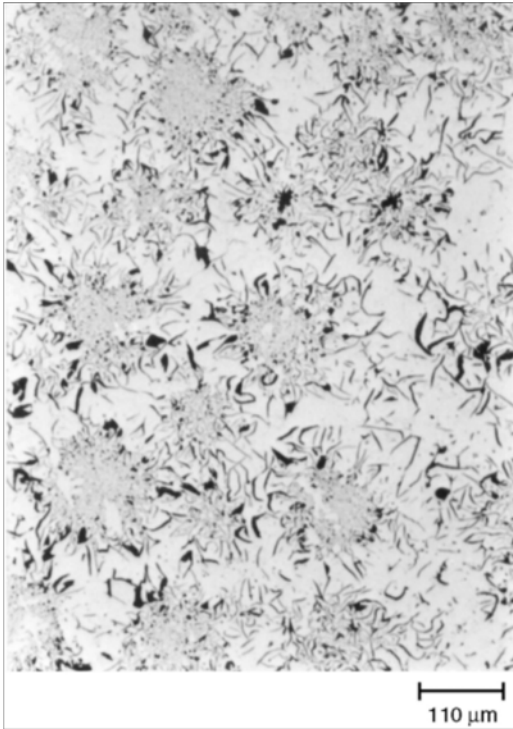
FIGURE V-61 – Microstructure d’une fonte hypereutectique, avec des plaquettes de type B. Source: ASM International Handbook online , Vol. 9, 2005.
