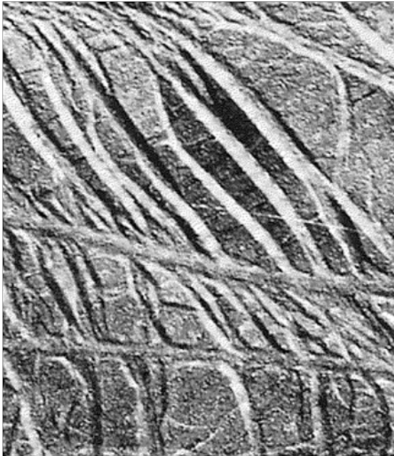
FIGURE IV-19 – Vermiculures dans une tôle en acier 1008 après déformation juste au-dessus de la limite élastique
