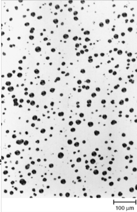
FIGURE V-65 – Graphite sphéroïdal dans une fonte à 4.14% pds C_{eq} . Source: ASM International Handbook online , Vol. 9, 2005.
